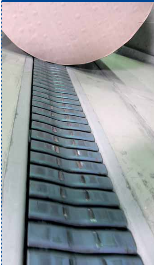
Пласти́нная цепь типа V с шагом 63 мм
