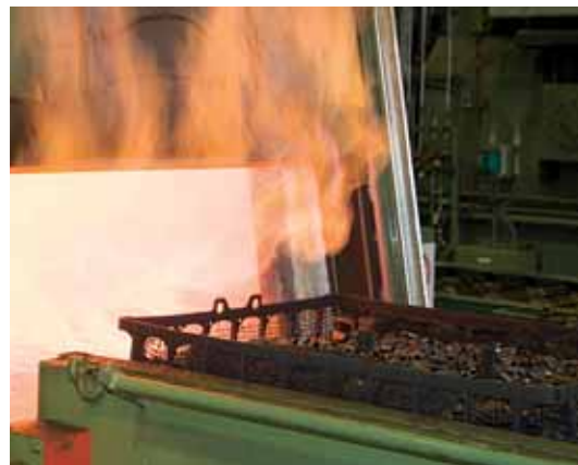
Закаливание в печах с газозащитной средой придает деталям цепи однородные качественные характеристики.
