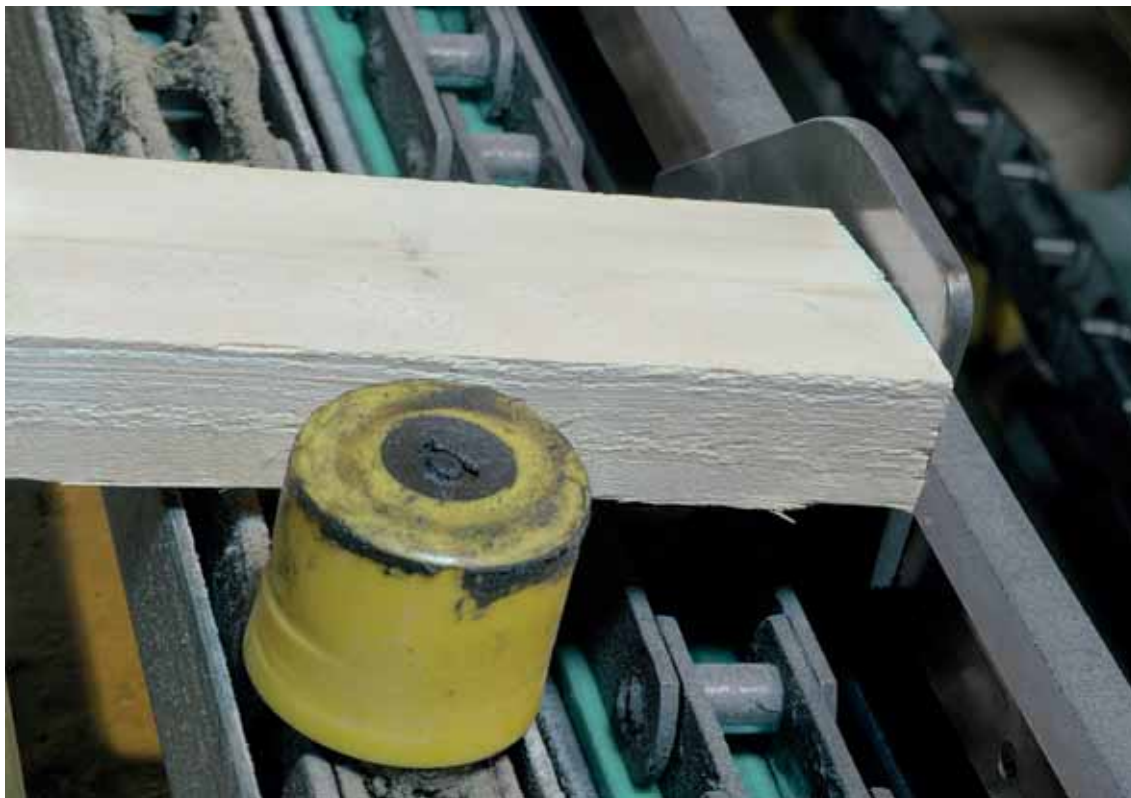
Со стороны возврата цепь можно подвешивать за захваты, но это вызывает их износ.
