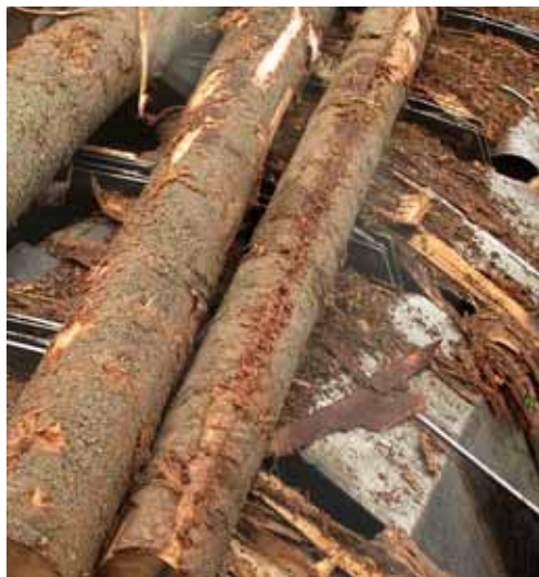
Для впередистаночных столов для бревен износ боковой пластины цепи может быть уменьшен за счет применения усиленных боковых пластин.
