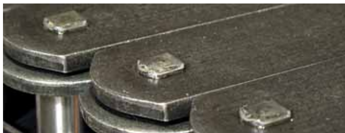
Места расклейки выдерживают усталость металла, поскольку торец пальца прочный.
