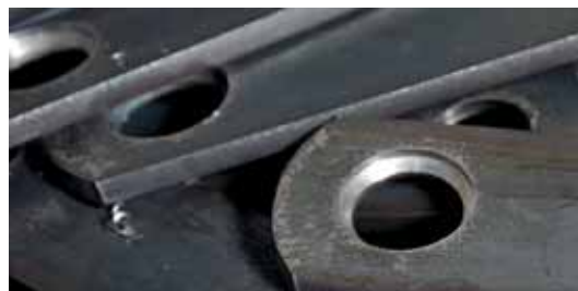
На боковых пластинах делают скос перед привариванием втулок.
