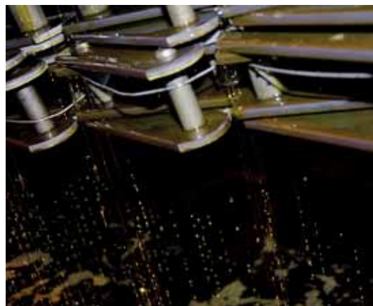
В масляной ванне каждый шарнир цепи получает тщательную смазку.
